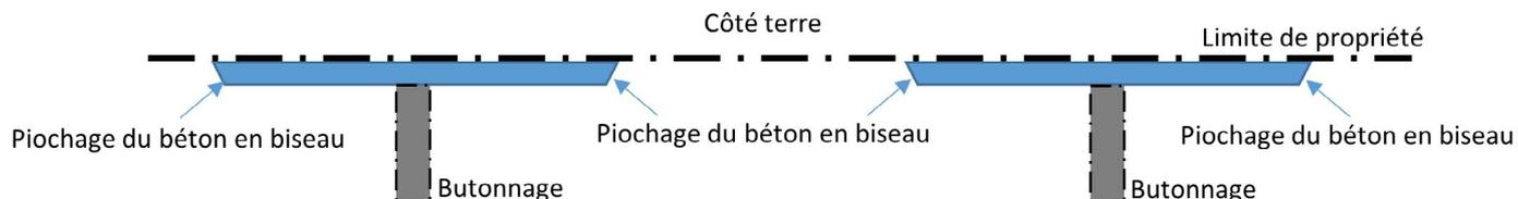
Figure 4-1 : Illustration du principe de piochage du béton en limite des passes adjacentes – Schéma en plan
